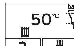
Osnovni prikaz tada pokazuje aktualno stanje proizvoda. Ako pritisnete tipku za odabir, onda se na displeju prikazuje aktivirana funkcija.
